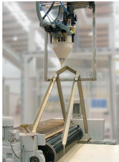
Le mélangeur fonctionne automatiquement lorsque l'un des détecteurs de niveau mesure un niveau bas de colle dans l'encolleuse, les composants arrivent instantanément au mélangeur dynamique à disque et le mélange collant est déposé en continu dans les rouleaux de l'encolleuse (supérieur ou inférieur selon le détecteur activé). En cas d'absence de l'un des composants une alarme est activée. Quand le niveau de colle dans les rouleaux est rétabli, le mélangeur s'arrête.
